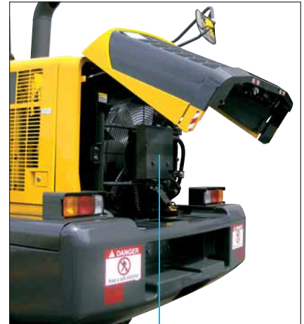
Hydraulic driven fan
