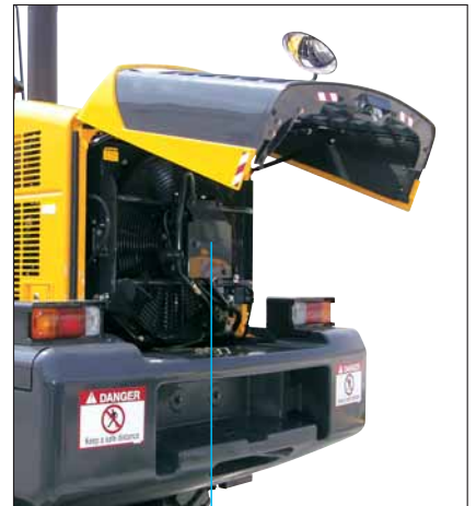
Hydraulic driven fan
