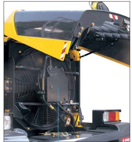
Hydraulic driven fan
