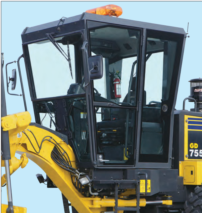
كابينة بتصميم هيكل الحماية من الانقلاب (ROPS) (ISO 3471) (مجهزة بمزيل الصقيع وممسحة بالتناوب)
